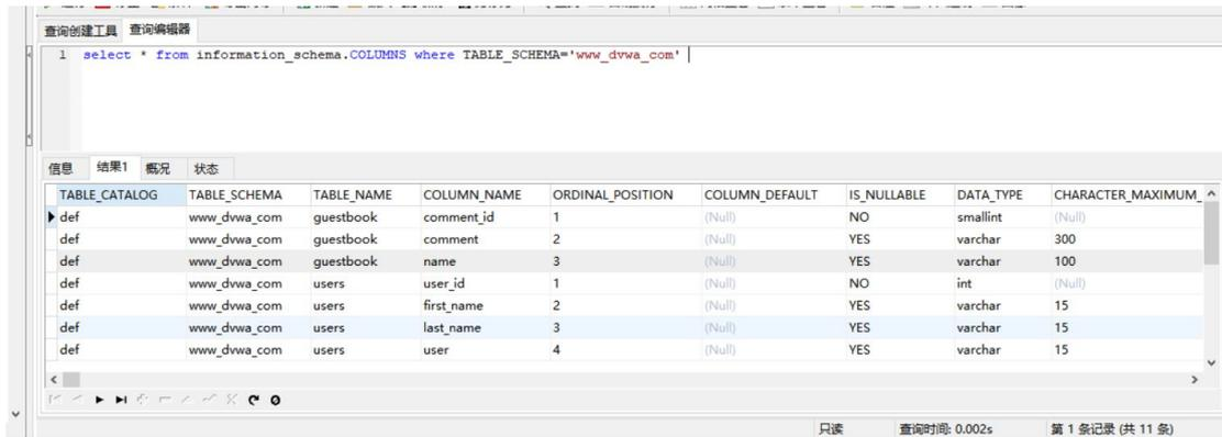
查询某个库某个表的字段可以这样查询
