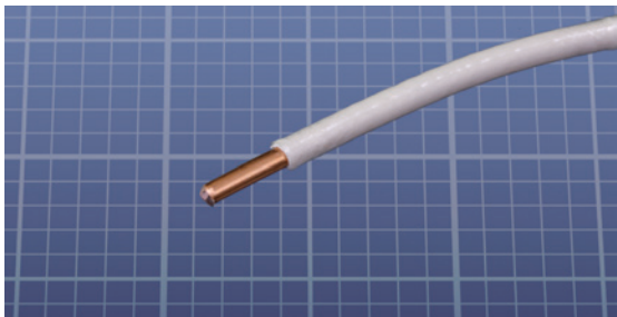
图 2-13 在塑料绝缘层内部，应该有一股实芯导线芯
