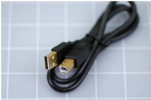
图 5-81 你需要用这种 USB 连接线连接 Arduino 电路板和计算机的 USB 端口
