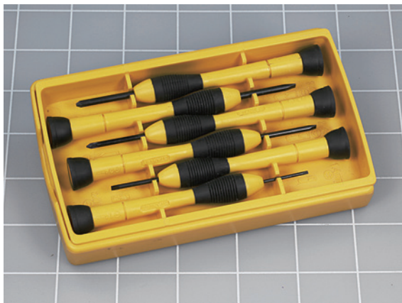
图 2-1 小螺丝刀，有扁平刀片，也有十字刀片。白线的间隔为 1 英寸
