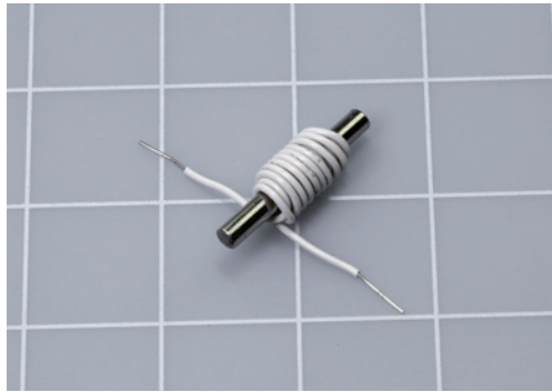
图 5-17 增加线圈匝数会使磁铁移动时产生的电压更大
