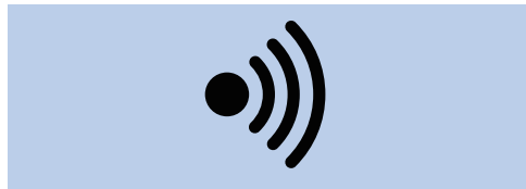
图 1-7 这个符号表示检测电路连续性的选项，带有声音反馈，这是非常实用的功能
