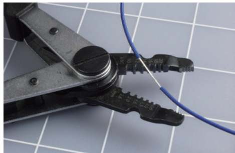
图 5-66 用剥线钳和手指将绝缘层向后拉约半英寸
