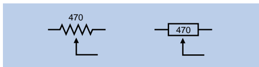
图 2-45 美国使用左侧的电位器符号，欧洲使用右侧的电位器符号
