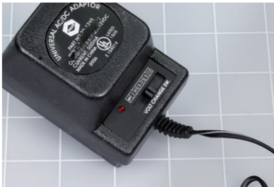
图 3-1 这件交流适配器插在墙上，允许你通过拨动小开关选择各种直流电压值
