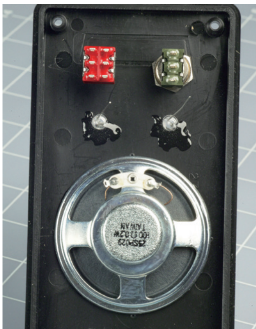
图 4-57 元件安装到了项目盒的控制面板上（从下方看去）。扬声器粘贴到了自己的位置上，多余的胶水粘到了 LED 上，以防万一
