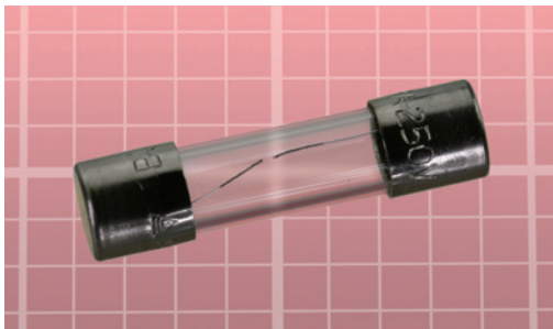
图 1-38 在被短路的套筒保险丝中出现了类似的熔断
