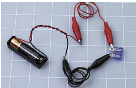
图 1-35 如何熔断汽车保险丝
