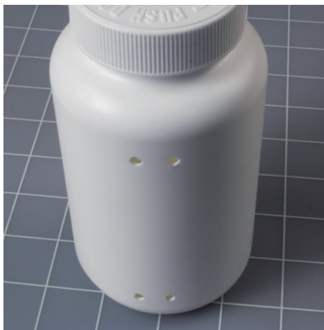
图 5-64 小孔用于固定绕在瓶身上的导线
