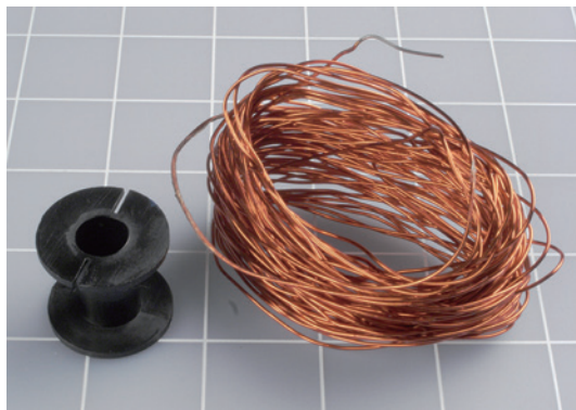
图 5-56 音频分频线圈由塑料线轴和铜线构成，没有其他结构
