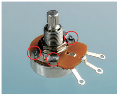
图 1-48 将电位器保持一体的金属片
