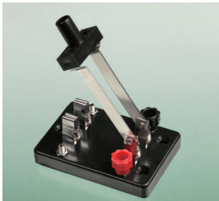
图 2-30 双极双掷（DPDT）开关，有两个完全互相隔离的极。每个极只能与一个触点连接
