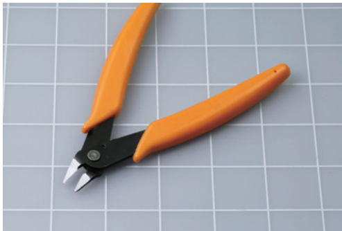
图 2-5 相比剪线钳，平口钳可以进入更狭小的空间
