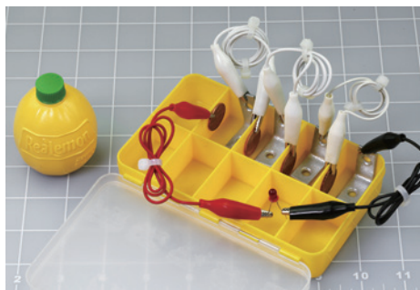
图 1-65 鲜榨柠檬汁或瓶装柠檬汁都会产生可靠的结果，虽然实验设备看起来很一般。这是一个零件盒，被改造成了四节柠檬汁电池
