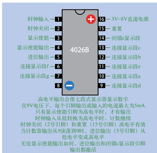
图 4-67 4026B 计数器芯片的引脚分配，输出译码能驱动七段式单数字 LED 显示器
