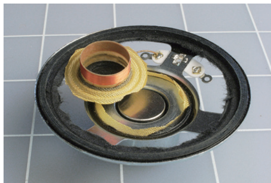
图 5-28 铜质线圈通常隐藏在磁铁的凹槽内
