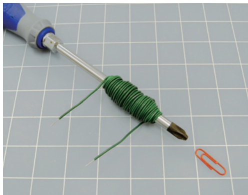
图 5-9 最简单的电磁铁恰好能吸引一枚回形针
