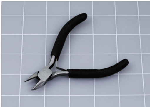
图 2-4 剪线钳应该不长于5英寸
