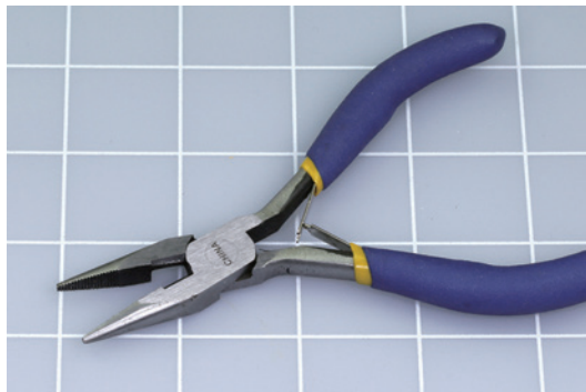
图 2-2 电子学工作适合的钳子应该不长于5英寸
