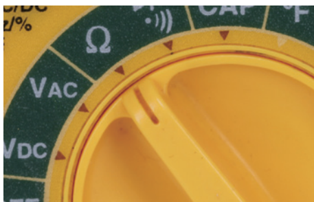
图 1-22 只需将自调量程万用表的刻度盘拨至欧姆符号即可
