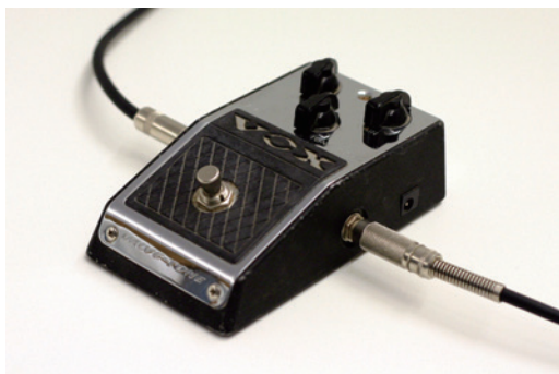
图 5-60 这个发出哇哇声的模糊音效果器是早期效果器的一种，它故意引起了音频工程师数十年来一直避免的削波失真
