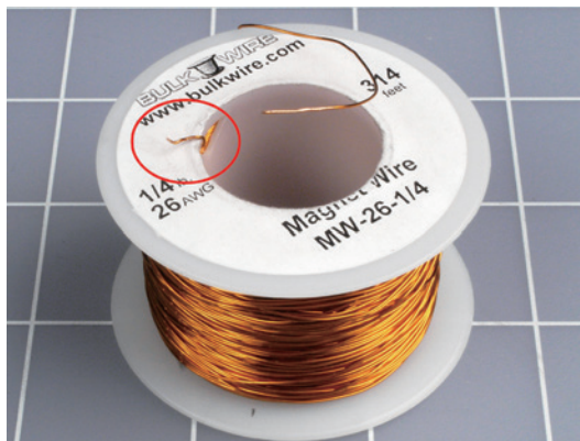
图 5-20 一卷线圈线，可以找到线的内端（红圈标记处）
