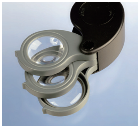
图 3-6 手持放大镜对检查焊接点非常重要
