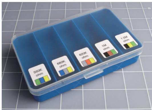
图 5-5 为了检查电阻器是否放错了隔间，可以在每条标签上印刷颜色编码
