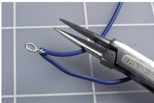
图 5-67 将裸露部分的导线拧成圆环
