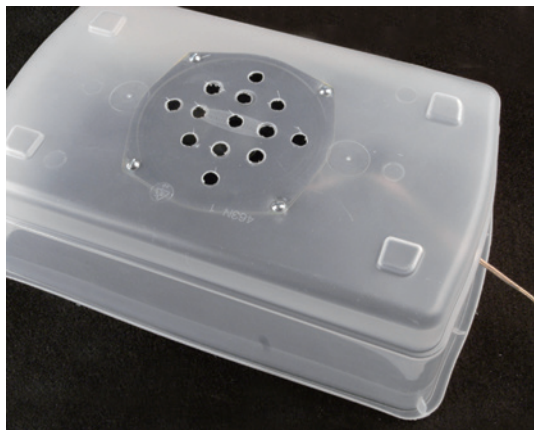
图 5-41 如果你想听到扬声器发出较低频率的声音（低音），就很有必要使用共振外壳。便宜的塑料储存箱足以满足演示目的
