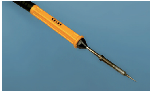
图 3-3 用于精确电子焊接工作的低功率烙铁
