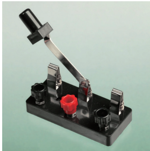
图 2-29 单极双掷（SPDT）开关，一个极可选择几个触点
