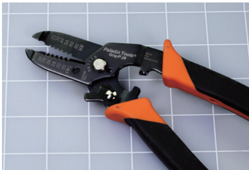
图 2-8 推荐的剥线钳用于处理 20 线规至 30 线规的导线
