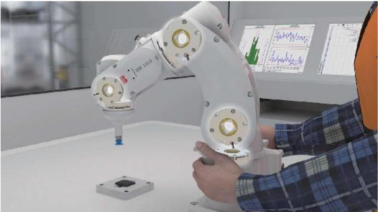
图4-11 “史上最小”六轴工业机器人——IRB 1010
