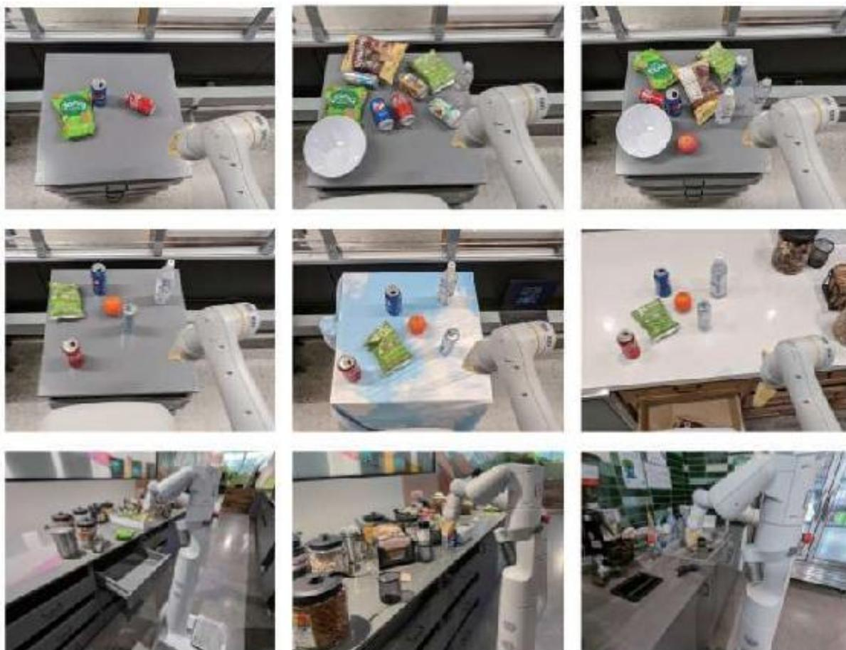
图4-13 RT-1机器人在不同维度上的泛化能力测试
