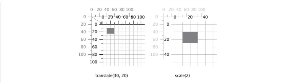
图 6-9：先平移后缩放的工作原理
