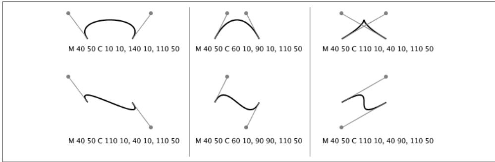
图 7-12：三次曲线控制点组合的结果
