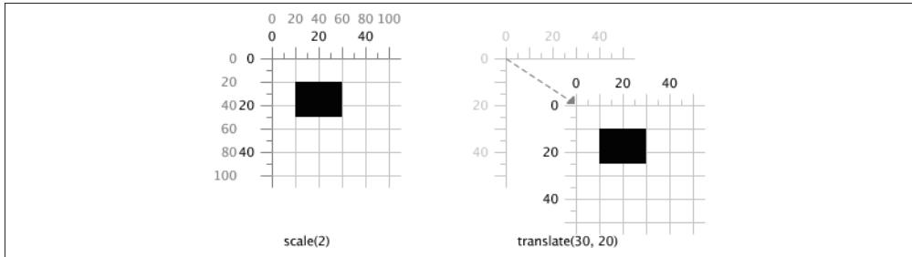
图 6-11：先缩放后平移的工作原理
