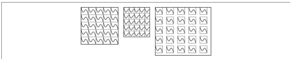
图 8-2：基于 `objectBoundingBox` 排列的图案
