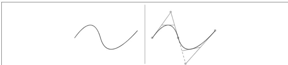
图 7-10：平滑的多边二次贝塞尔曲线
