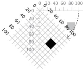
图 6-17：围绕原点旋转的工作原理
