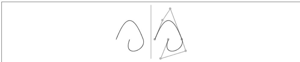
图 7-13：多条连接在一起的三次贝塞尔曲线
